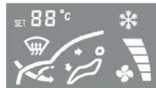
شکل ۷۱ LCD کنترل تهویه مطبوع
