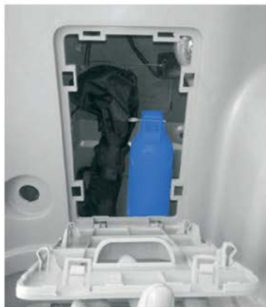
◀ شکل ۱۵۴ محل کپسول آتش‌نشانی
